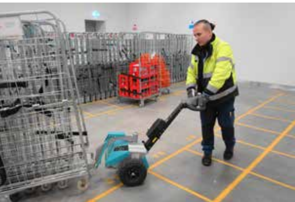
Den eldrivna vagnsdragaren Ergothruster underlättar lagerarbetet. På bilden Jabel Isa.
