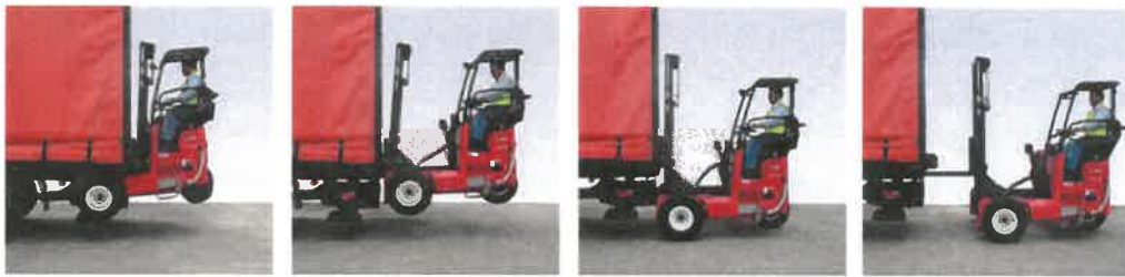
Bilder: Påhängstruck för lastning och lossning som hänger längs bak på fordon tillåts utöver fordonslängd i flera länder t.ex. Finland och Danmark.
