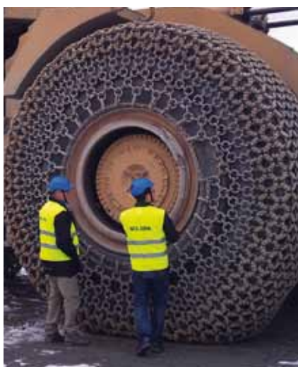
I Aitikgruvan finns Europas största maskiner. Bergtruckar som lastar 300 ton, endast hjulet är 3,4 m i diameter, grävmaskiner som rymmer upp till 80 ton berg i skoporna,
